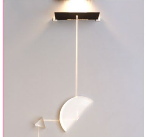
FIG. 6 Réflexion totale de la lumière dans un demi-cylindre en verre.
